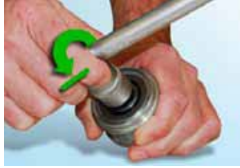
Şekil 4: Saatin tersi yönde hareket ettiğinde alet anında sıkışır ve dönmez.
