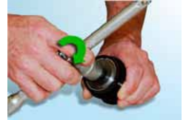
Şekil 7: Alet düşük bir dirençle saat yönünde sürekli olarak dönebilir.
