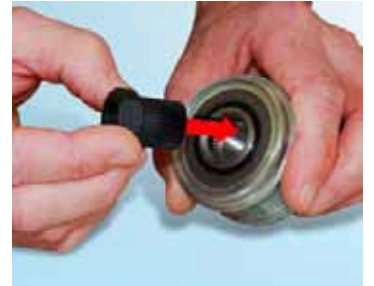
Şekil 3: Doğru anahtar devir ayarlı alternatör kasnağı takılmış.
