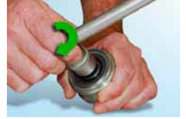
Şekil 5: Alet düşük bir dirençle saat yönünde sürekli olarak dönebilir.
