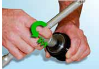
Şekil 6: Alet saatin tersi yönde hareket ettiğinde artan şiddette bir yay kuvveti hissedeceksiniz.
